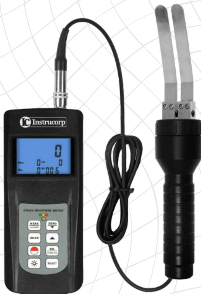
Medidor de Umidade para alta precisão que utiliza métodos de medição por contato para avaliar o teor de umidade em papel.
