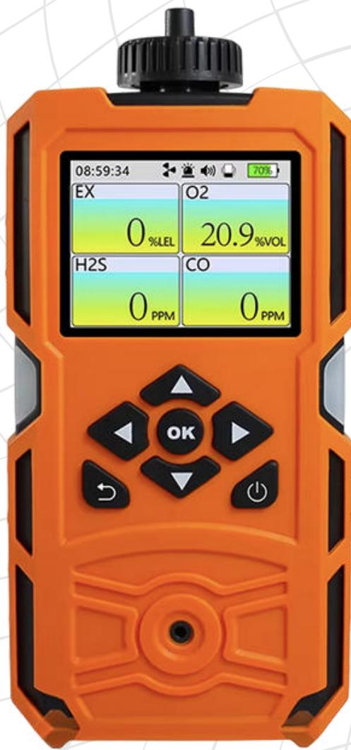
**Um dispositivo confiável para detecção de gases, capaz de monitorar em tempo real gases combustíveis, oxigênio, monóxido de carbono e sulfeto de hidrogênio.**
